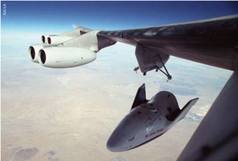
X-38 wurde zu Testzwecken von einem B 52 Bomber auf große Höhe gebracht und abgeworfen 👁
