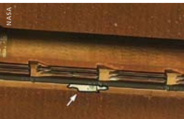
Gleich nach der Abtrennung vom Außentank fotografieren die Astronauten die Stelle, an der sich das Stück abgelöst hat. 👁
