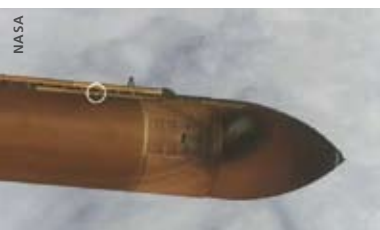
Ein Stück vom Tank fällt unmittelbar nach dem Absprengen der Feststoffbooster ab.
