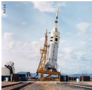
Vorbereitung des „High Altitude Abort Tests“ in White Sands auf einer Little Joe II Rakete.
