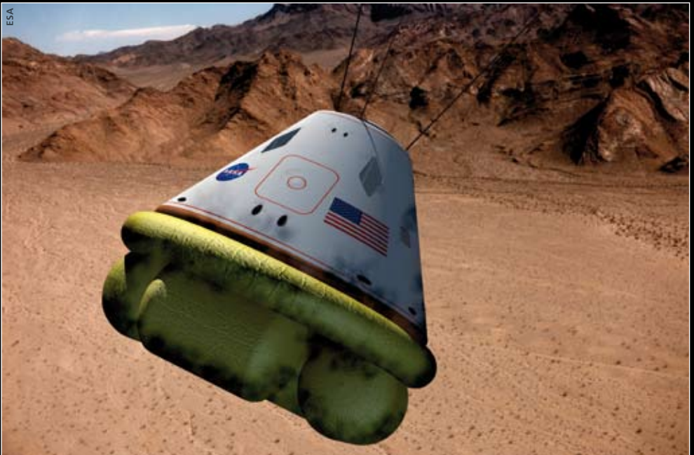
Projekt Constellation: Die Landung der Kapsel erfolgt nicht wie bei Apollo im Meer, sondern auf Land, abgedefert mit Airbags à la Pathfinder, Spirit & Co.
