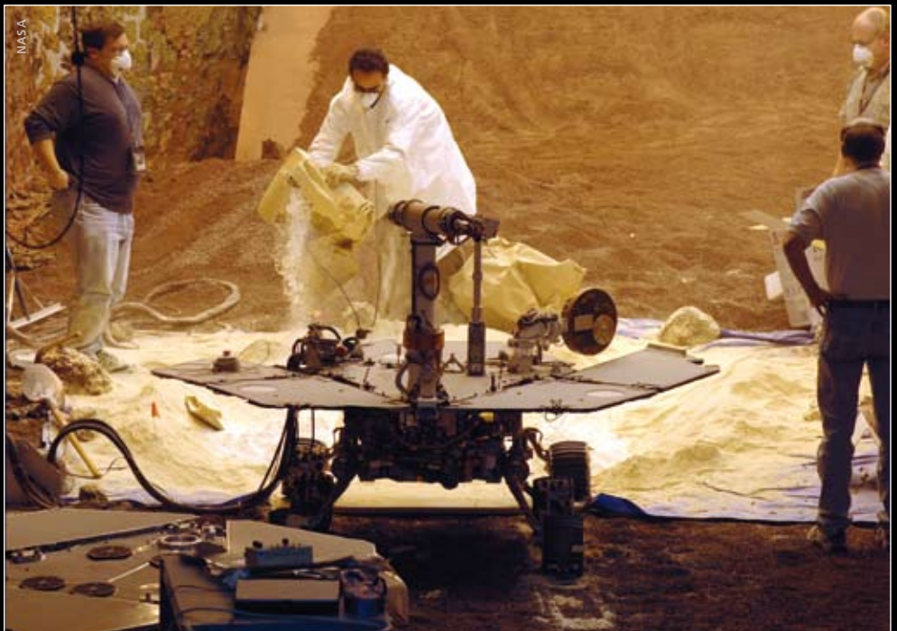
Anfang Mai 2005: Die Rover-Ingenieure erproben im Testaufbau des Jet Propulsion Laboratory Methoden, um Opportunity wieder flott zu bekommen.
