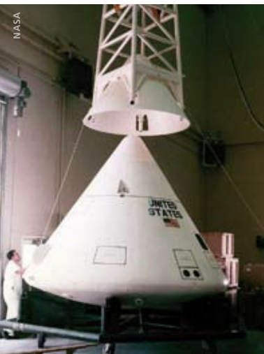
Eine frühe Version des Startturms wird auf eine Apollo-Testkapsel gesetzt
