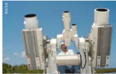
Eine der Bahnverfolgungs-Kameras, von denen die NASA einige Dutzend einsetzen wird.
