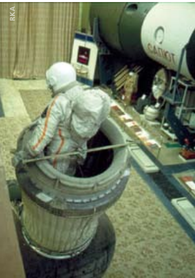
Die aufblasbare Schleuse, durch die Leonow Woschod 2 verließ
