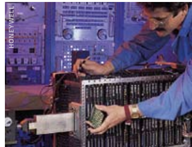
Das hier ist ein Block II Space Shuttle Main Engine Controller. Jeder dieser MEC's ist direkt am Haupttriebwerk angebracht. Gut erkennbar: Elektronik der siebziger Jahre. Aber enorm robust
