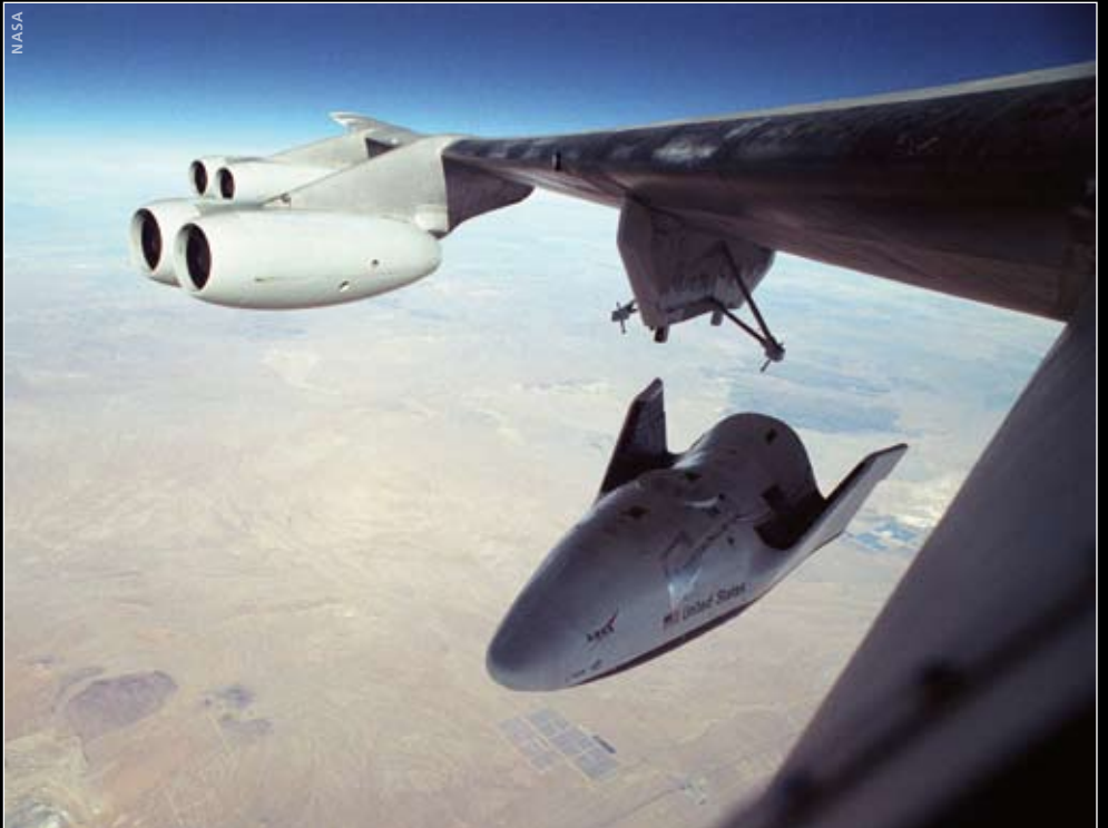
X-38 wurde zu Testzwecken von einem B 52 Bomber auf große Höhe gebracht und abgeworfen
