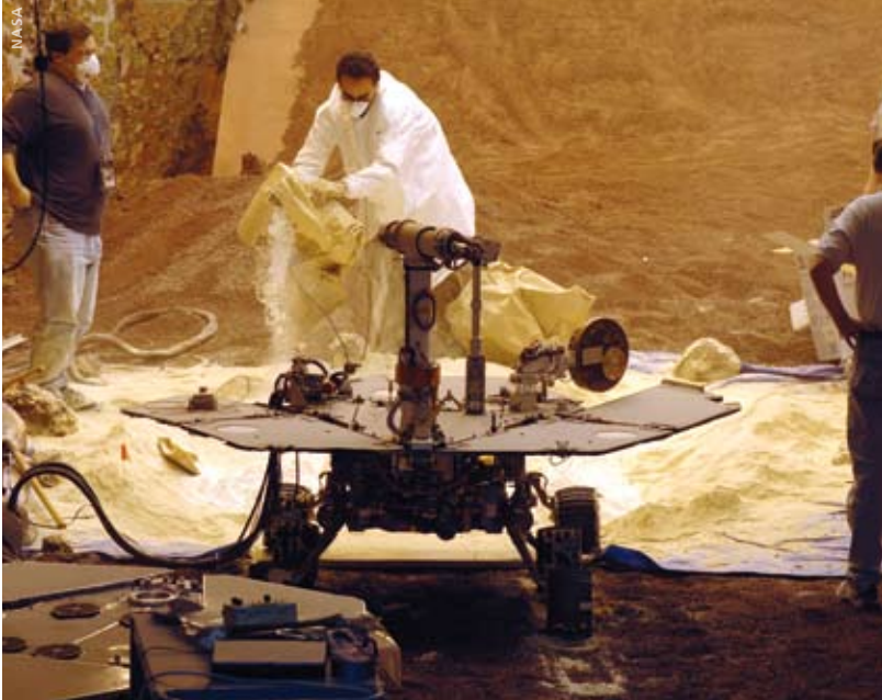
Anfang Mai 2005: Die Rover-Ingenieure erproben im Testaufbau des Jet Propulsion Laboratory Methoden um Opportunity wieder flott zu bekommen 👁
