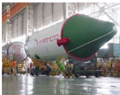
Progress M53 wird zur Integration mit der Trägerrakete vorbereitet
