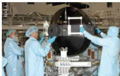
Der fast 300 Kilogramm schwere Lagekontrollkreisler den die Discovery zur Raumstation bringen soll.
