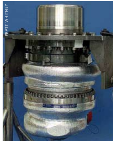
Das hier ist eine Treibstoff Hochdruck Turbopumpe. Hergestellt wird sie von Pratt & Whitney. Diese Firma stellt auch die Sauerstoff Hochdruck Turbopumpe her. Pratt und Witney liefert somit für jeden Shuttle sechs Pumpen. Die Wasserstoffpumpe leistet 76.000 PS und die Sauerstoffpumpe 26.800 PS.
