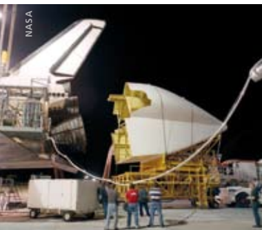
Die Discovery bekommt ihren „Tailcone“, eine aerodynamische Verkleidung für den Rücktransport zum Cape.
