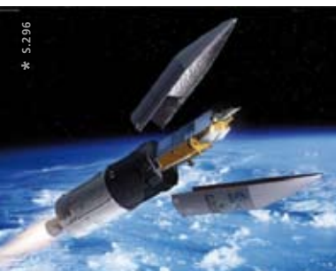
Die Trennung der Nutzlastverkleidung – künstlerische Darstellung
