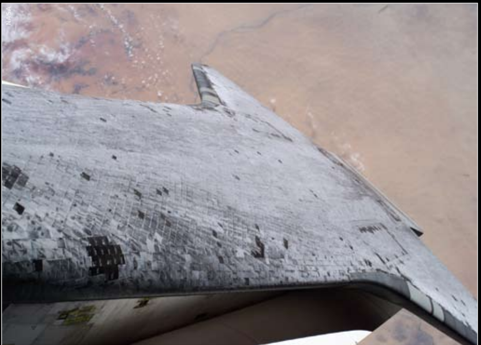
STS-114: Gut zu sehen auf diesem Bild, das Stephen K. Robinson während des dritten EVA's machte, die Hitzeschutzkacheln auf der Unterseite der Discovery,
