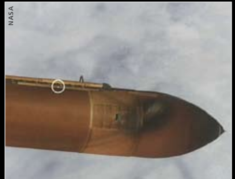
STS-114: Gleich nach der Abtrennung vom Außentank fotografieren die Astronauten die Stelle, an der sich das Stück abgelöst hat.
