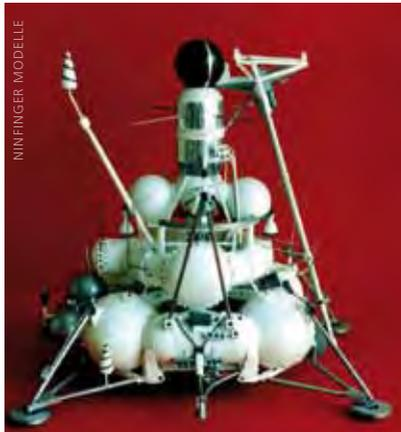
So sah Luna 24 aus. Die Materialproben wurden in der schwarzen Kugel an der Spitze des Raumfahrzeugs zur Erde zurück gebracht.
