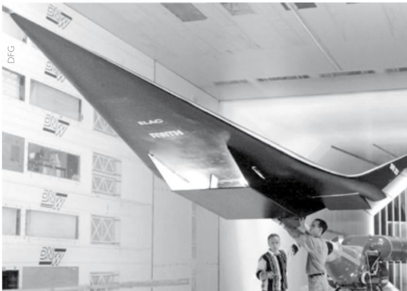
Bild 3: Für die Untersuchung der Umströmung des Raumflugzeugs in Windkanälen wurden mehrere Modelle bis zu einer Länge von sechs Metern gebaut. Hier ist das Modell ELAC des Sonderforschungsbereiches der RWTH Aachen gezeigt.
