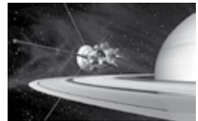
*Bezieht Energie aus der Zerfallswärme von Plutonium: Raumsonde Cassini.*
