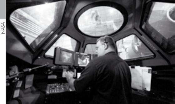
*Blin in die Zukunft: Trainingsleiter Paul Williamson bedient in einer Simulation den kanadischen Roboterarm von einem Mockup des „Cupola“ Moduls aus. Diese Kuppel wird ab 2009 den Astronauten eine Rundumsicht auf die ISS gewähren und die Koordination von Außeneinsätzen erleichtern.*
