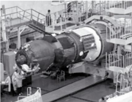
1-3: Progress 13P wird in Baikonur mit der Trägerrakete integriert.
